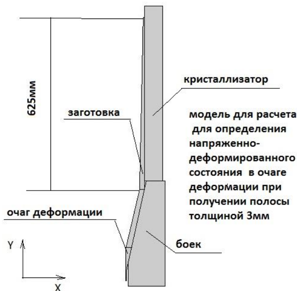
Рис. 5. Положения заготовки, кристаллизатора и стенки-бойка для обеспечения выхода полосы толщиной 8 мм перед началом рабочего хода
